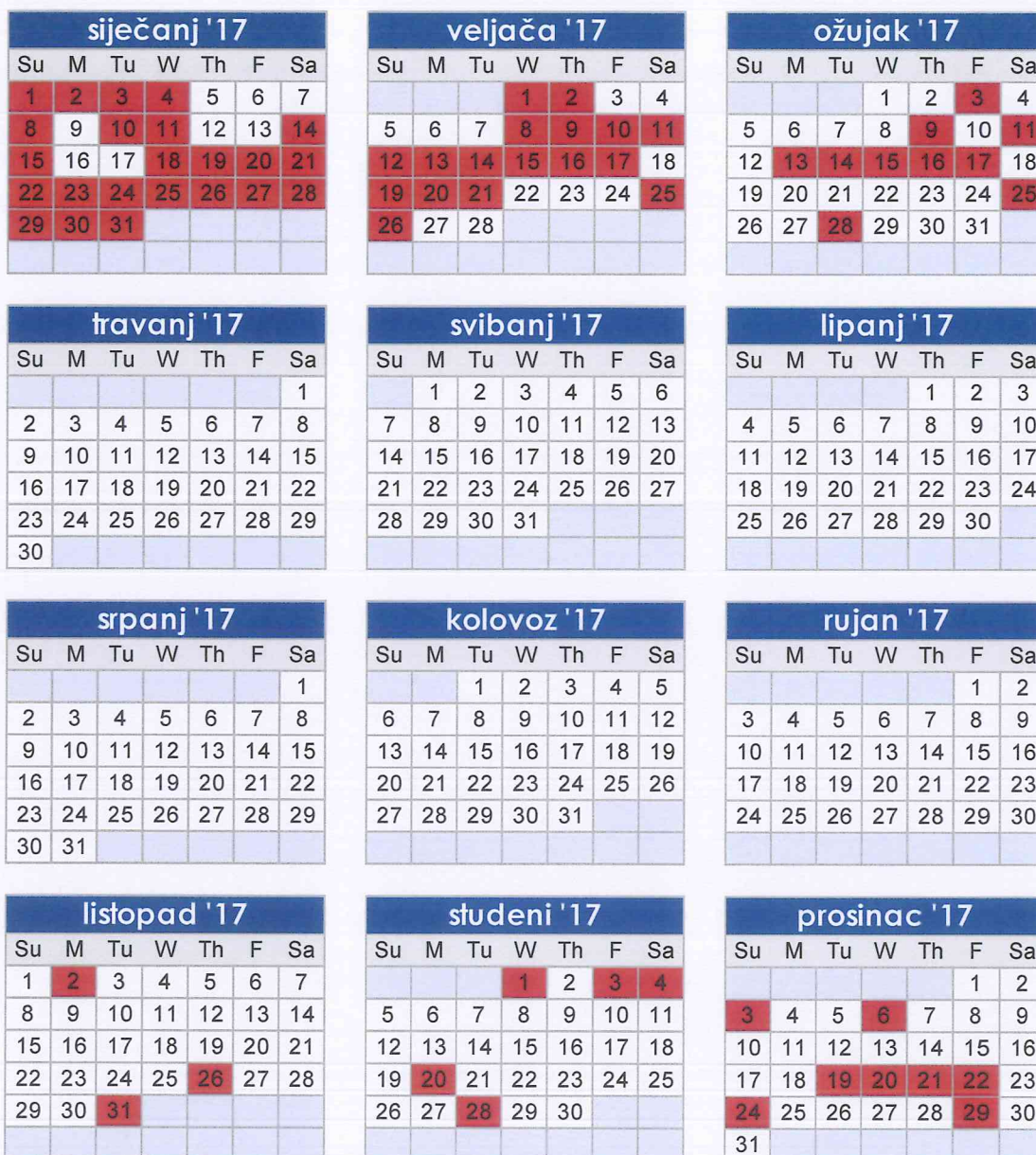
Slika 4. Kalendar prekoračenja GV koncentracija PM_{10} za 24-satno vrijeme usrednjavanja u 2017. godini na postaji Međunarodna zračna luka Zagreb
